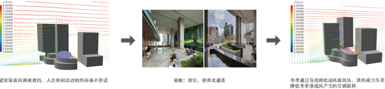
图5 运用 Phoenix 软件对初模进行风环境模拟
