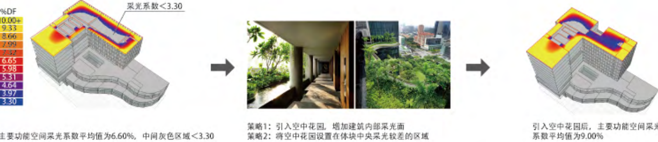
图6 运用 EcoTect 软件对初模进行采光模拟
