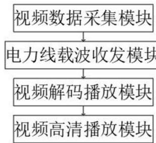
1. 基于电力线载波与深度学习融合的电力监控系统,其特征在于,包括视频数据采集模块,用于捕获视频图像数据以及视频音频数据;
